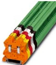
Blocs de jonction simple, Mode de raccordement: Raccordement vissé, Nombre de connexions: 2, Section :0,14 mm<sup>2</sup> - 6 mm<sup>2</sup>, AWG: 26 - 10, Largeur: 6,2 mm, Coloris: orange, Type de montage: NS 35/7,5, NS 35/15
