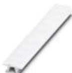
Repérage ZB, Rubans, blanc, repéré, repérable avec : CMS-P1-PLOTTER, impression longitudinale: numérotation continue 1-10, 11-20, etc. jusqu'à 491-500, Type de montage: Encliquetage dans la rainure de repérage élevée, pour bloc de jonction au pas de : 6,2 mm, Surface utile: 6,15 x 10,5 mm
