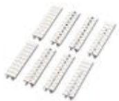
Repérage ZB, Rubans, blanc, repéré, repérable avec : CMS-P1-PLOTTER, impression transversale: numérotation continue 1-10, 11-20, etc. jusqu'à 491-500, Type de montage: Encliquetage dans la rainure de repérage élevée, pour bloc de jonction au pas de : 5,2 mm, Surface utile: 5,15 x 10,5 mm
