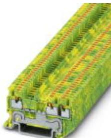
Bloc de jonction pour conducteur de protection, Mode de raccordement: Raccordement Push-in, Section :0,14 mm<sup>2</sup> - 1,5 mm<sup>2</sup>, AWG: 26 - 14, Largeur: 3,5 mm, Hauteur: 30,5 mm, Coloris: vert/jaune, Type de montage: NS 35/7,5, NS 35/15
