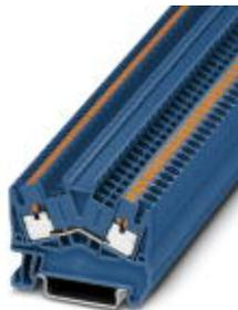
Blocs de jonction simple, Mode de raccordement: Raccordement Push-in, Nombre de connexions: 2, Section :0,14 mm<sup>2</sup> - 4 mm<sup>2</sup>, AWG: 26 - 12, Largeur: 5,2 mm, Coloris: bleu, Type de montage: NS 35/7,5, NS 35/15
