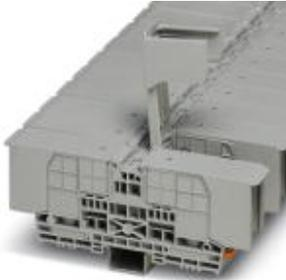
Bloc de jonction à tige filetée, type de raccordement: Raccordement par tige filetée, nombre de connexions: 2, nombre de pôles: 1, largeur: 29 mm, hauteur: 66 mm, coloris: gris, type de montage: NS 35/7,5, NS 35/15, Vissage direct
