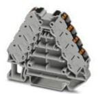
Distributeurs de potentiel, Tension nominale: 250 V, Intensité nominale: 17,5 A, Section : 0,14 mm² - 2,5 mm², AWG: 14 - 26, Mode de raccordement: Raccordement Push-in, Nombre de pôles: 2, Nombre de connexions: 16, Largeur: 8,3 mm, Longueur: 64 mm, Coloris: gris, Couleur des éléments de raccordement: noir, Montage: NS 35/7,5, NS 35/15
