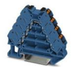
Distributeurs de potentiel, Tension nominale: 250 V, Intensité nominale: 17,5 A, Section : 0,14 mm² - 2,5 mm², AWG: 14 - 26, Mode de raccordement: Raccordement Push-in, Nombre de pôles: 2, Nombre de connexions: 16, Largeur: 8,3 mm, Longueur: 64 mm, Coloris: bleu, Couleur des éléments de raccordement: noir, Montage: NS 35/7,5, NS 35/15
