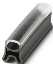
Repères pour fils, transparent/noir, vierge, type de montage: enfilage, plage de diamètre de câble: 2 ... 4 mm, surface utile: 23 x 4 mm
