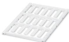
Etiquettes à encliqueter, Planche, blanc, vierge, repérable avec : TOPMARK NEO, LASER TOPMARK, BLUEMARK ID COLOR, BLUEMARK ID, BLUEMARK CLED, THERMOMARK PRIME, THERMOMARK CARD 2.0, THERMOMARK CARD, type de montage: insérer, surface utile: 25 x 6 mm, Nombre d'étiquettes: 15
