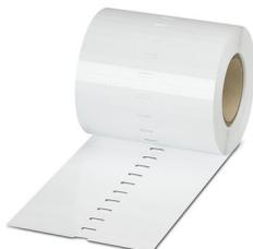
Etiquette, Rouleau, blanc, vierge, repérable avec : THERMOMARK E.300 (D)/600 (D), THERMOMARK ROLL 2.0, THERMOMARK ROLL, THERMOMARK ROLL X1, THERMOMARK ROLLMASTER 300/600, THERMOMARK X1.2, type de montage: insérer, plage de diamètre de câble: 10 ... 25 mm, surface utile: 25 x 6 mm, Nombre d'étiquettes: 5000
