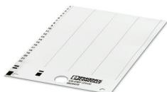
Etiquettes à encliqueter, Carte, blanc, vierge, repérable avec : BLUEMARK ID COLOR, BLUEMARK ID, THERMOMARK PRIME, THERMOMARK CARD 2.0, THERMOMARK CARD, type de montage: insérer, surface utile: 26 x 6,1 mm, Nombre d'étiquettes: 88
