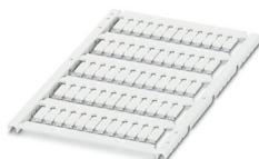
Repères pour blocs de jonction, pour le repérage des blocs de jonction Entrelec, Planche, blanc, vierge, repérable avec : THERMOMARK CARD, THERMOMARK CARD 2.0, THERMOMARK PRIME, BLUEMARK ID, BLUEMARK ID COLOR, LASER TOPMARK, TOPMARK NEO, type de montage: encliquetage, pour bloc de jonction au pas de : 5 mm, surface utile: 3,85 x 9,3 mm, Nombre d'étiquettes: 60
