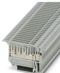
Blocs de jonction simple, tension nominale: 800 V, intensité nominale: 24 A, 1er étage connexion à droite, type de raccordement: Raccordement vissé, Section de référence: 2,5 mm<sup>2</sup>, section: 0,2 mm<sup>2</sup> - 4 mm<sup>2</sup>, type de raccordement: Raccordement par clips, montage: NS 35/7,5, NS 35/15, coloris: gris
