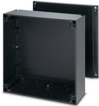
Boîtier vide, avec deux niveaux de câblage, matériau: Polyester renforcé en fibres de verre, avec graphique ajouté, noir, 360 mm x 360 mm x 145 mm, type de verrouillage: Couvercle vissé
