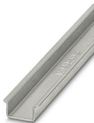
Profilé plein, Conditionnement par 10 unités (20 m), selon EN 60715, matériau: Acier, galvanisé, traité par passivation couche épaisse, Profil standard 2,3 mm, coloris: argenté
