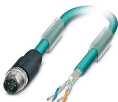
Câble préconfectionné pour bus, Ethernet CAT5 (100 Mbit/s), 4-pôles exempt d'halogène, blindé, connecteur mâle droit M12, détrompage: D, sur extrémité libre, longueur de câble: 5 m
