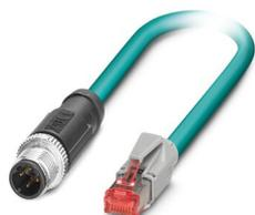
Câble de réseau, Ethernet CAT5 (100 Mbit/s), 4-pôles blindé (Advanced Shielding Technology), connecteur mâle droit M12, détrompage: D / IP67, sur connecteur mâle droit RJ45 / IP20, longueur de câble: 1 m
