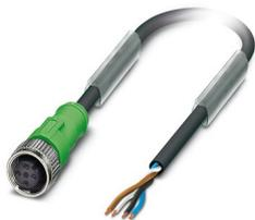
Câble pour capteurs/actionneurs, 4-pôles exempt d'halogène, extrémité libre, sur Connecteur femelle droit M12, détrompage: A, longueur de câble: 10 m
