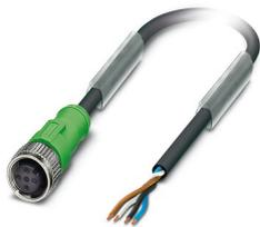
Câble pour capteurs/actionneurs, 4-pôles exempt d'halogène, extrémité libre, sur Connecteur femelle droit M12, détrompage: A, longueur de câble: 5 m
