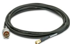
Câble d'antenne, diamètre extérieur : 5 mm, conducteur interne : rigide, atténuation : 0,9 / 1,3 / 2,0 dB à 0,9 / 2,4 / 5,8 GHz, raccordement : N (mâle) -> RSMA (mâle), longueur de câble : 2 m
