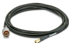
Câble d'antenne, diamètre extérieur : 5 mm, conducteur interne : rigide, atténuation : 1,2 / 2,0 / 3,0 dB à 0,9 / 2,4 / 5,8 GHz, raccordement : N (mâle) -> RSMA (mâle), longueur de câble : 3 m
