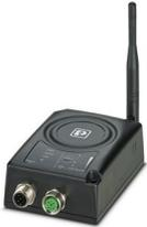
Module radio Ethernet combiné avec Bluetooth et WLAN, antenne omnidirectionnelle échangeable jointe, WLAN : AP et Client, 2,4 et 5 GHz, Bluetooth : 2.1+EDR/4.0, PAN jusqu'à 7 connexions, IP65, 9 ... 30 V DC, raccordement M12, WEB, commandes AT et bouton de mode
