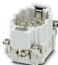
Élément de contact, nombre de pôles: 10+PE, taille: B6, contacts de puissance: 10, contacts de commande: 0, nombre de raccordements par pôle: 1, Mâle, Raccordement Push-in, 500 V, 16 A, 0,5 mm<sup>2</sup> ... 2,5 mm<sup>2</sup>, application: Puissance
