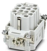
Élément de contact, nombre de pôles: 10+PE, taille: B6, contacts de puissance: 10, contacts de commande: 0, nombre de raccordements par pôle: 1, Connecteur femelle, Raccordement Push-in, 500 V, 16 A, 0,5 mm<sup>2</sup> ... 2,5 mm<sup>2</sup>, application: Puissance
