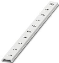
Ruban de repérage ZB, plat, Rubans, blanc, repéré, impression longitudinale: numérotation continue 1 ... 10, 11 ... 20, etc. jusqu'à 91 ... 100, type de montage: encliquetage, pour bloc de jonction au pas de : 7,5 mm, surface utile: 5,15 x 7,4 mm, Nombre d'étiquettes: 10
