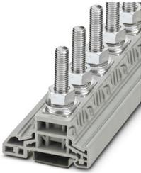
Connecteur de puissance, tension nominale: 1000 V, intensité nominale: 269 A, nombre de connexions: 1, type de raccordement: Raccordement par tige filetée, Section de référence: 120 mm<sup>2</sup>, type de montage: NS 35/7,5, NS 35/15, coloris: gris
