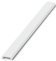
Ruban de repérage ZB, plat, à commander : par bandes, blanc, impression selon les indications du client, type de montage: encliquetage dans la rainure de repérage plate, pour bloc de jonction au pas de : 7,5 mm, surface utile: 5,15 x 7,4 mm, Nombre d'étiquettes: 10
