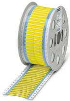
Gaine thermorétractable, Rouleau, jaune, vierge, repérable avec : THERMOMARK E.300 (D)/600 (D), THERMOMARK ROLLMASTER 300/600, THERMOMARK ROLL X1, THERMOMARK ROLL, THERMOMARK ROLL 2.0, THERMOMARK W, THERMOMARK X1.2, perforé, type de montage: enfilage, plage de diamètre de câble: 1 ... 3,2 mm, surface utile: 30 x 5 mm, Nombre d'étiquettes: 5000
