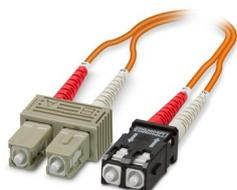
Câble FO équipé, câble Zipcord, fibre de verre multimode 50/125  $\mu\text{m}$ , OM2, connecteurs : SC-Duplex / SC-RJ, indice de protection : IP20, pour goulottes ou armoires électriques
