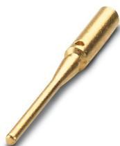
Contact à sertir, diamètre de contact: 0,6 mm, tournés, Mâle, matériau de contact: CuZn, surface des contacts: Ni/Au, section raccordable: 0,14 mm<sup>2</sup> ... 0,34 mm<sup>2</sup>, AWG 26 ... 22
