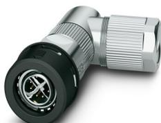
Connecteur de données, Ethernet CAT6<sub>A</sub> (10 Gbit/s), PROFINET CAT6<sub>A</sub> (10 Gbit/s), 8-pôles, blindé, connecteur mâle coudé M12 Push-Pull, X, Raccordement à sertir, matériau de la molette: PA 6.6, diamètre extérieur du câble 6,5 mm ... 10 mm, sans contacts à sertir
