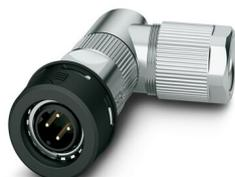
Connecteur de données, PROFINET CAT5 (100 Mbit/s), 4-pôles, blindé, connecteur mâle coudé M12 Push-Pull, D, Raccordement à sertir, matériau de la molette: PA 6.6, diamètre extérieur du câble 4,5 mm ... 7,5 mm, sans contacts à sertir
