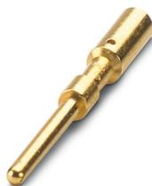
Contact à sertir, diamètre de contact: 1 mm, tournés, Mâle, matériau de contact: CuZn, surface des contacts: Ni/Au, section raccordable: 0,34 mm<sup>2</sup> ... 1 mm<sup>2</sup>, AWG 22 ... 18
