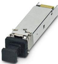
Module SFP gigabit pour la transmission jusqu'à une distance de 10 km avec une longueur d'onde de 1310 nm.
