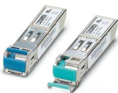
Module SFP-WFM pour la transmission jusqu'à une distance de 10 km sur une fibre avec une longueur d'onde de 1310/1550 nm.
