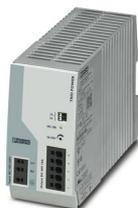
Alimentation TRIO POWER à découpage primaire avec raccordement Push-in pour montage sur profilé, entrée : monophasée, sortie : 48 V DC/10 A
