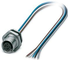
Connecteur d'appareil face arrière, Universel, 5-pôles, connecteur femelle, droit, M12-Push-Pull, détrompage: A, sur extrémité libre, Montage face arrière, M16 x 1,5, Cordons individuels, longueur de câble: 0,5 m, 0,34 mm<sup>2</sup>, Cordon TPE, Produit de remplacement selon RoHS II sans exception 6c (Pb < 0,1 %) référence : 1238099
