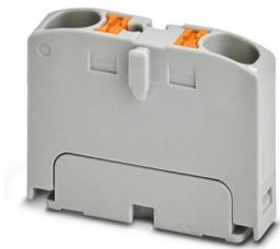
Bloc distributeur, Module de base, tension nominale: 800 V, intensité nominale: 32 A, nombre de connexions: 2, type de raccordement: Raccordement Push-in, Section de référence: 4 mm<sup>2</sup>, section : 0,2 mm<sup>2</sup> - 6 mm<sup>2</sup>, type de montage: encliquetage sur l'adaptateur de profilé, Montage direct avec bride, Volant, coloris: gris
