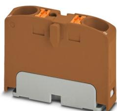
Bloc distributeur, Module de base, tension nominale: 800 V, intensité nominale: 32 A, nombre de connexions: 2, type de raccordement: Raccordement Push-in, Section de référence: 4 mm<sup>2</sup>, section : 0,2 mm<sup>2</sup> - 6 mm<sup>2</sup>, type de montage: encliquetage sur l'adaptateur de profilé, Montage direct avec bride, Volant, coloris: marron
