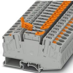
Bloc de jonction à fonction, tension nominale: 1000 V, intensité nominale: 32 A, type de raccordement: Raccordement Push-in, Section de référence: 6 mm<sup>2</sup>, section : 0,5 mm<sup>2</sup> - 10 mm<sup>2</sup>, montage: NS 35/7,5, NS 35/15, NS 32, coloris: gris
