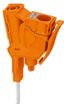
Bloc de jonction de dérivation, tension nominale: 1000 V, intensité nominale: 32 A, nombre de connexions: 2, type de raccordement: Raccordement Push-in, 1er étage, Section de référence: 6 mm<sup>2</sup>, section : 0,5 mm<sup>2</sup> - 10 mm<sup>2</sup>, type de montage: Montage par enfichage, coloris: orange
