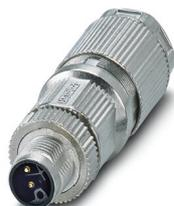
Connecteur de puissance, Puissance, 4-pôles, blindé, connecteur mâle droit M12, L, Raccordement à sertir, matériau de la molette: Zinc moulé sous pression, étamé, diamètre extérieur du câble 8 mm ... 13 mm, sans contacts à sertir
