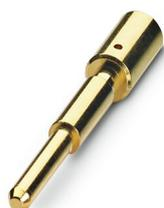
Contact à sertir, diamètre de contact: 1,5 mm, tournés, Mâle, matériau de contact: CuZn, surface des contacts: Ni/Au, section raccordable: 2,5 mm<sup>2</sup> ... 2,5 mm<sup>2</sup>, AWG 14
