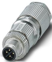
Connecteur de puissance, Puissance, 4-pôles, blindé, connecteur mâle droit M12, S, Raccordement à sertir, matériau de la molette: Zinc moulé sous pression, étamé, diamètre extérieur du câble 6,5 mm ... 11 mm, sans contacts à sertir, Contact 4 à fermeture
