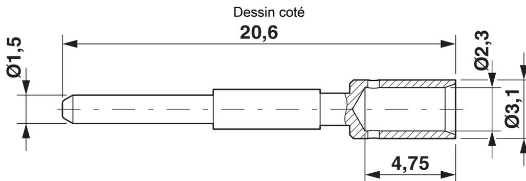
Contact à sertir, diamètre : 1,5 mm
