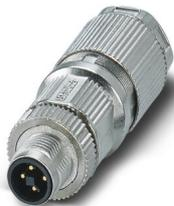
Connecteur de puissance, Puissance, 4-pôles, blindé, connecteur mâle droit M12, T, Raccordement à sertir, matériau de la molette: Zinc moulé sous pression, étamé, diamètre extérieur du câble 6,5 mm ... 11 mm, sans contacts à sertir, Contact 4 à fermeture
