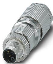
Connecteur de puissance, Puissance, 5-pôles, blindé, connecteur mâle droit M12, K, Raccordement à sertir, matériau de la molette: Zinc moulé sous pression, étamé, diamètre extérieur du câble 8 mm ... 13 mm, sans contacts à sertir
