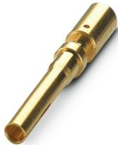
Contact à sertir, diamètre de contact: 1,5 mm, tournés, Connecteur femelle, matériau de contact: CuZn, surface des contacts: Ni/Au, section raccordable: 2,5 mm<sup>2</sup> ... 2,5 mm<sup>2</sup>, AWG 14, pour le raccordement PE ou FE
