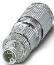
Connecteur de puissance, Puissance, 5-pôles, blindé, connecteur mâle droit M12, L, Raccordement à sertir, matériau de la molette: Zinc moulé sous pression, étamé, diamètre extérieur du câble 8 mm ... 13 mm, sans contacts à sertir
