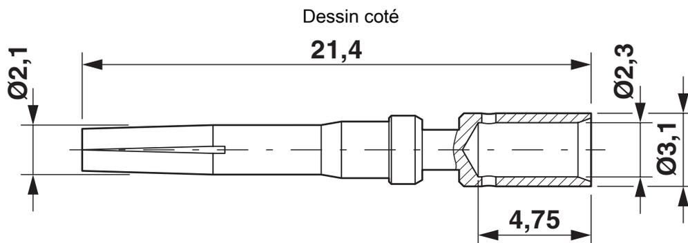
Contact à sertir, diamètre : 1,5 mm
