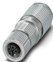
Connecteur de puissance, Puissance, 4-pôles, blindé, connecteur femelle droit M12, L, Raccordement à sertir, matériau de la molette: Zinc moulé sous pression, étamé, diamètre extérieur du câble 8 mm ... 13 mm, sans contacts à sertir
