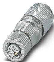
Connecteur de puissance, Puissance, 5-pôles, blindé, connecteur femelle droit M12, L, Raccordement à sertir, matériau de la molette: Zinc moulé sous pression, étamé, diamètre extérieur du câble 8 mm ... 13 mm, sans contacts à sertir, Contact 5 à fermeture
