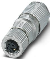
Connecteur de puissance, Puissance, 5-pôles, blindé, connecteur femelle droit M12, K, Raccordement à sertir, matériau de la molette: Zinc moulé sous pression, étamé, diamètre extérieur du câble 8 mm ... 13 mm, sans contacts à sertir, Contact 5 à fermeture
