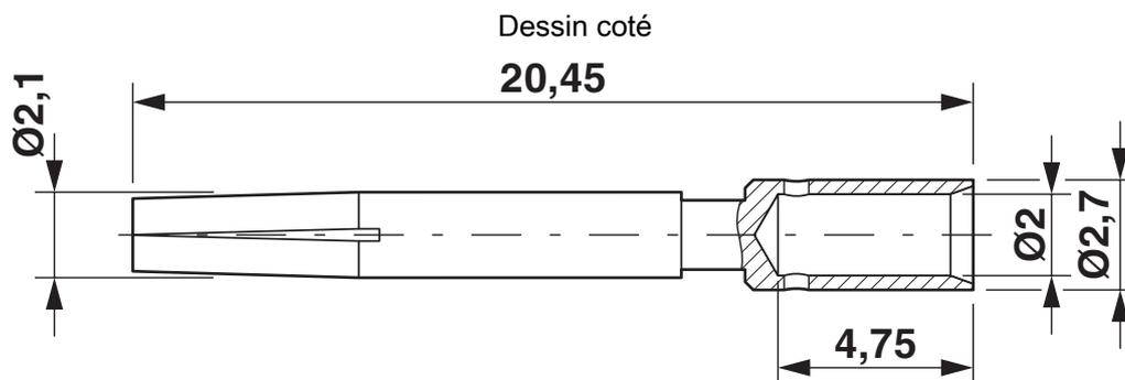
Contact à sertir, diamètre : 1,5 mm
