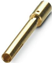
Contact à sertir, diamètre de contact: 1,5 mm, tournés, Connecteur femelle, matériau de contact: CuZn, surface des contacts: Ni/Au, section raccordable: 1,5 mm<sup>2</sup> ... 1,5 mm<sup>2</sup>, AWG 14
