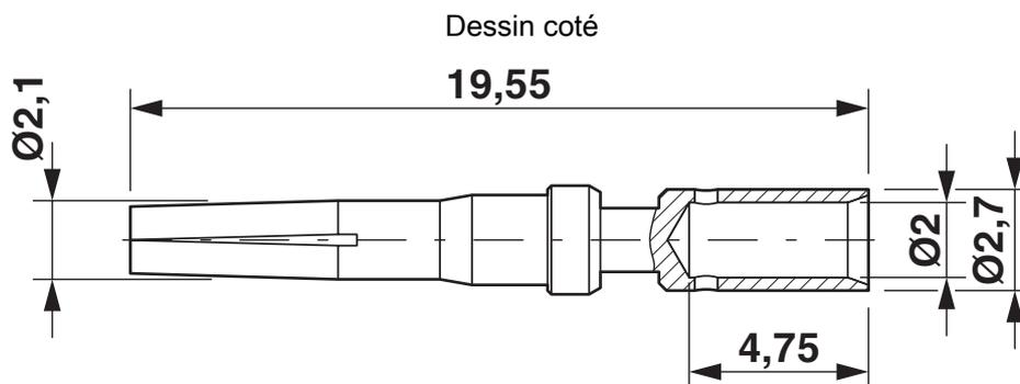
Contact à sertir, diamètre : 1,5 mm
