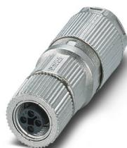
Connecteur de puissance, Puissance, 4-pôles, blindé, connecteur femelle droit M12, T, Raccordement à sertir, matériau de la molette: Zinc moulé sous pression, étamé, diamètre extérieur du câble 6,5 mm ... 11 mm, sans contacts à sertir
