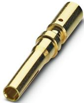
Contact à sertir, diamètre de contact: 1,5 mm, tournés, Connecteur femelle, matériau de contact: CuZn, surface des contacts: Ni/Au, section raccordable: 1,5 mm<sup>2</sup> ... 1,5 mm<sup>2</sup>, AWG 14, pour le raccordement PE ou FE
