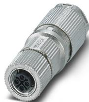
Connecteur de puissance, Puissance, 4-pôles, blindé, connecteur femelle droit M12, S, Raccordement à sertir, matériau de la molette: Zinc moulé sous pression, étamé, diamètre extérieur du câble 6,5 mm ... 11 mm, sans contacts à sertir
