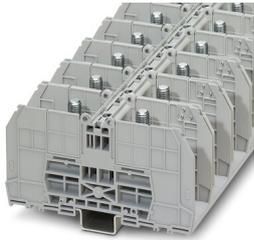
Bloc de jonction à tige filetée, tension nominale: 1000 V, intensité nominale: 309 A, nombre de connexions: 2, nombre de pôles: 1, type de raccordement: Raccordement par tige filetée, Section de référence: 150 mm<sup>2</sup>, type de montage: NS 35/7,5, NS 35/15, coloris: gris
