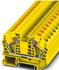
Blocs de jonction simple, tension nominale: 1000 V, intensité nominale: 76 A, nombre de connexions: 2, type de raccordement: Raccordement Push-in, Section de référence: 16 mm<sup>2</sup>, section : 0,5 mm<sup>2</sup> - 25 mm<sup>2</sup>, type de montage: NS 35/7,5, NS 35/15, coloris: jaune
