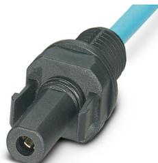
Embases paroi avant, Famille d'articles: Sunclix, matériau du boîtier: PPE, coloris: noir, nombre de pôles: 1, section de fil min.: 2,5 mm<sup>2</sup>, tension de référence: 1000 V DC, courant de référence: 27 A, Type de raccordement: Sertissage, Type de contact: Connecteur femelle, longueur de câble: 115
