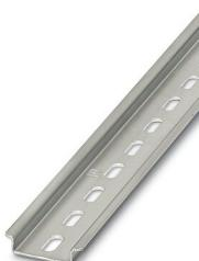
Profilé percé, selon EN 60715, matériau: Acier, galvanisé, traité par passivation couche épaisse, Profil standard, coloris: argent, Conditionnement par 25 unités (50 m)
