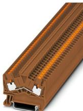
Blocs de jonction simple, tension nominale: 800 V, intensité nominale: 24 A, nombre de connexions: 2, type de raccordement: Raccordement Push-in, 1er étage, Section de référence: 2,5 mm<sup>2</sup>, section : 0,14 mm<sup>2</sup> - 4 mm<sup>2</sup>, type de montage: NS 35/7,5, NS 35/15, coloris: marron
