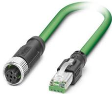
Câble de réseau, PROFINET CAT5 (100 Mbit/s), EtherCAT® CAT5 (100 Mbit/s), 4-pôles, blindé (Advanced Shielding Technology), Connecteur femelle droit M12, détrompage: D / IP67, sur connecteur mâle droit RJ45 / IP20, longueur de câble: 1 m
