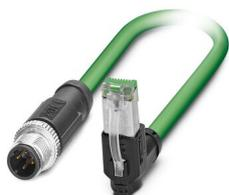
Câble de réseau, PROFINET CAT5 (100 Mbit/s), EtherCAT® CAT5 (100 Mbit/s), 4-pôles, Type de câble variable, blindé, connecteur mâle droit M12, détrompage: D SPEEDCONNEX / IP67, sur connecteur mâle coudé RJ45 / IP20, longueur de câble: Longueur au choix (0,2... 40,0 m)
