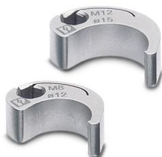
Embout enfichable pour le montage de câbles de capteurs/actionneurs munis de connecteurs M12 et de connecteurs M12 à équiper avec diamètre d'écrou moleté de 15 mm, pour emmanchement à six pans de 4 mm
