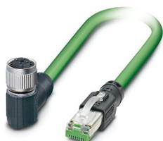
Câble de réseau, PROFINET CAT5 (100 Mbit/s), EtherCAT® CAT5 (100 Mbit/s), 4-pôles, Type de câble variable, blindé, Connecteur femelle coudé M12, détrompage: D SPEEDCONNEC / IP67, sur connecteur mâle droit RJ45 / IP20, longueur de câble: Longueur au choix (0,2... 40,0 m)
