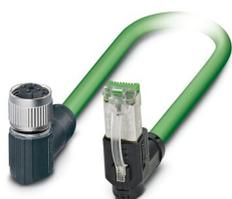
Câble de réseau, PROFINET CAT5 (100 Mbit/s), EtherCAT® CAT5 (100 Mbit/s), 4-pôles, Type de câble variable, blindé, Connecteur femelle coudé M12, détrompage: D SPEEDCONNEC / IP67, sur connecteur mâle coudé RJ45 / IP20, longueur de câble: Longueur au choix (0,2... 40,0 m)
