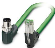
Câble de réseau, PROFINET CAT5 (100 Mbit/s), EtherCAT® CAT5 (100 Mbit/s), 4-pôles, Type de câble variable, blindé, connecteur mâle coudé M12, détrompage: D SPEEDCONNEC / IP67, sur connecteur mâle coudé RJ45 / IP20, longueur de câble: Longueur au choix (0,2... 40,0 m)
