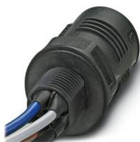
Traversée de paroi, Raccordement QUICKON, nombre de pôles: 4+PE, 690 V, 20 A, noir, sans écrou QUICKON, filetage de montage: M25, Fils individuels (soudé), 2,5 mm<sup>2</sup>, fils coupés nets, longueur du câble: 1 m
