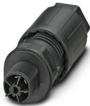
Traversée de paroi, Raccordement QUICKON, nombre de pôles: 4+PE, 690 V, 15 A, noir, avec écrou QUICKON, diamètre extérieur du câble: 6 mm ... 11 mm, filetage de montage: M20, Raccordement par clips (pour clips selon DIN 46247-2)
