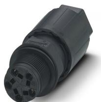
Traversée de paroi, Raccordement QUICKON, nombre de pôles: 4+PE, 690 V, 20 A, noir, avec écrou QUICKON, diamètre extérieur du câble: 6 mm ... 11 mm, filetage de montage: M25, Raccordement Push-in
