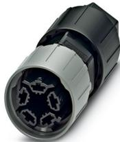
Connecteur mâle QUICKON, noir, 4 pôles + PE, 1,0 mm<sup>2</sup> ... 2,5 mm<sup>2</sup> / 690 V / 20 A, avec écrou QUICKON, pour câbles d'un diamètre de 6 mm ... 11 mm.
