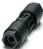
Prolongateur de câble QUICKON, noir, 4 pôles + PE, 1,0 mm<sup>2</sup> ... 2,5 mm<sup>2</sup> / 690 V / 20 A, pour diamètre de câble de 6 mm ... 11 mm.
