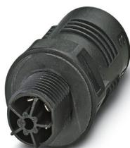
Traversée de paroi, Raccordement QUICKON, nombre de pôles: 4+PE, 690 V, 15 A, noir, sans écrou QUICKON, filetage de montage: M20, Raccordement par clips (pour clips selon DIN 46247-2)
