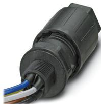
Traversée de paroi, Raccordement QUICKON, nombre de pôles: 4+PE, 690 V, 20 A, noir, avec écrou QUICKON, diamètre extérieur du câble: 6 mm ... 11 mm, filetage de montage: M25, Fils individuels (soudé), 2,5 mm<sup>2</sup>, fils coupés nets, longueur du câble: 0,5 m
