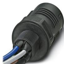
Traversée de paroi, Raccordement QUICKON, nombre de pôles: 4+PE, 690 V, 20 A, noir, sans écrou QUICKON, filetage de montage: M20, Fils individuels (soudé), 2,5 mm<sup>2</sup>, fils coupés nets, longueur du câble: 1 m
