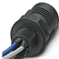
Traversée de paroi, Raccordement QUICKON, nombre de pôles: 4+PE, 690 V, 20 A, noir, sans écrou QUICKON, filetage de montage: M25, Fils individuels (soudé), 2,5 mm<sup>2</sup>, fils coupés nets, longueur du câble: 0,5 m
