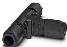
Répartiteur en T QUICKON, noir, 4 pôles + PE, 2,5mm<sup>2</sup> ... 6,0 mm<sup>2</sup> / 690 V / 40 A, pour diamètres de câble de 9 mm ... 14 mm, avec trois écrous Quickon
