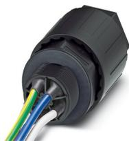
Traversée de paroi QUICKON, 4 pôles + PE, 2,5 mm<sup>2</sup> ... 6,0 mm<sup>2</sup> / 690 V / 40 A, avec écrou QUICKON, noir, pour diamètre de câble 9 mm ... 14 mm, filetage M25 avec 5 fils soudés de 6,0 mm<sup>2</sup>, 1,0 m de long, coupe lisse à l'extrémité.
