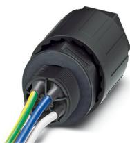
Traversée de paroi QUICKON, 4 pôles + PE, 2,5 mm<sup>2</sup> ... 6,0 mm<sup>2</sup> / 690 V / 40 A, avec écrou QUICKON, noir, pour diamètre de câble 9 mm ... 14 mm, filetage M25 avec 5 fils soudés de 6,0 mm<sup>2</sup>, 0,5 m de long, coupe lisse à l'extrémité.
