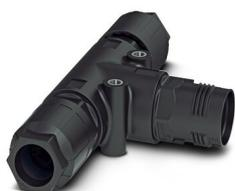
Répartiteur en T QUICKON, noir, 4 pôles + PE, 2,5mm<sup>2</sup> ... 6,0 mm<sup>2</sup> / 690 V / 40 A, pour diamètres de câble de 9 mm ... 14 mm, avec deux écrous Quickon
