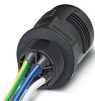
Traversée de paroi QUICKON, 4 pôles + PE, 2,5 mm<sup>2</sup> ... 6,0 mm<sup>2</sup> / 690 V / 40 A, sans écrou QUICKON, noir, filetage M25 avec 5 fils soudés de 6,0 mm<sup>2</sup>, 0,5 m de long, coupe lisse à l'extrémité.
