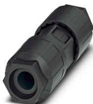
Prolongateur de câble QUICKON, noir, 4 pôles + PE, 2,5 mm<sup>2</sup> ... 6,0 mm<sup>2</sup> / 690 V / 40 A, pour diamètres de câble de 9 mm ... 14 mm.
