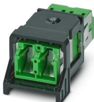
Prolongateur à FO, type: LC, indice de protection: IP20, nombre de pôles: 2, matériau: Plastique, type de raccordement: Prolongateur, sortie du câble: droit
