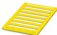
Repères pour blocs de jonction, à commander : sous forme de planche, jaune, impression selon les indications du client, type de montage: encliquetage dans la rainure de repérage plate, pour bloc de jonction au pas de : 16 mm, surface utile: 15,45 x 5,1 mm, Nombre d'étiquettes: 32
