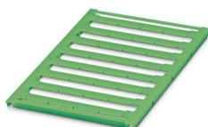
Repères pour blocs de jonction, à commander : sous forme de planche, vert, impression selon les indications du client, type de montage: encliquetage dans la rainure de repérage plate, pour bloc de jonction au pas de : 16 mm, surface utile: 15,45 x 5,1 mm, Nombre d'étiquettes: 32
