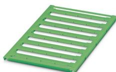
Repères pour blocs de jonction, Planche, vert, vierge, repérable avec : BLUEMARK ID COLOR, BLUEMARK ID, BLUEMARK CLED, PLOTMARK, CMS-P1-PLOTTER, type de montage: encliquetage, pour bloc de jonction au pas de : 16 mm, surface utile: 15,45 x 5,1 mm, Nombre d'étiquettes: 32
