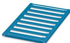
Repères pour blocs de jonction, à commander : sous forme de planche, bleu, impression selon les indications du client, type de montage: encliquetage dans la rainure de repérage plate, pour bloc de jonction au pas de : 16 mm, surface utile: 15,45 x 5,1 mm, Nombre d'étiquettes: 32
