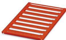
Repères pour blocs de jonction, à commander : sous forme de planche, rouge, impression selon les indications du client, type de montage: encliquetage dans la rainure de repérage plate, pour bloc de jonction au pas de : 16 mm, surface utile: 15,45 x 5,1 mm, Nombre d'étiquettes: 32
