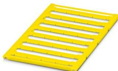
Repères pour blocs de jonction, Planche, jaune, vierge, repérable avec : BLUEMARK ID COLOR, BLUEMARK ID, BLUEMARK CLED, PLOTMARK, CMS-P1-PLOTTER, type de montage: encliquetage, pour bloc de jonction au pas de : 16 mm, surface utile: 15,45 x 5,1 mm, Nombre d'étiquettes: 32
