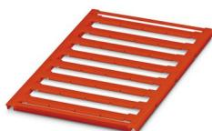
Repères pour blocs de jonction, Planche, rouge, vierge, repérable avec : BLUEMARK ID COLOR, BLUEMARK ID, BLUEMARK CLED, PLOTMARK, CMS-P1-PLOTTER, type de montage: encliquetage, pour bloc de jonction au pas de : 16 mm, surface utile: 15,45 x 5,1 mm, Nombre d'étiquettes: 32
