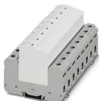
Parafoudres et parafoudres combinés enfichables, selon type 1+2 / classe I+II, pour réseaux électriques isolés triphasés, avec N et PE séparés (L1, L2, L3, N, PE).
