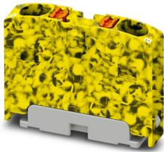
Bloc distributeur, Module de base, tension nominale: 450 V, intensité nominale: 17,5 A, nombre de connexions: 2, type de raccordement: Raccordement Push-in, section : 0,14 mm<sup>2</sup> - 2,5 mm<sup>2</sup>, type de montage: encliquetage sur l'adaptateur de profilé, Montage direct avec bride, Volant, coloris: noir/jaune
