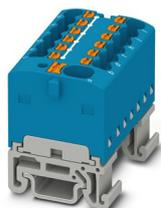
Bloc distributeur, intensité nominale: 41 A, nombre de connexions: 13, type de raccordement: Raccordement Push-in, Raccordement collectif, Section de référence: 4 mm<sup>2</sup>, section : 0,2 mm<sup>2</sup> - 6 mm<sup>2</sup>, Dérivation, section : 0,14 mm<sup>2</sup> - 2,5 mm<sup>2</sup>, type de montage: NS 15, coloris: bleu
