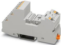
Embase de relais RIF-2.../EX à équiper de relais industriels étanches RTIII à 4 contacts inverseurs pour l'utilisation en zone 2, raccordement Push-in, enfichabilité pour modules d'entrée/antiparasite, montage sur NS 35/7,5
