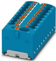
Bloc distributeur, Module de base avec alimentation, intensité nominale: 41 A, nombre de connexions: 19, type de raccordement: Raccordement Push-in, Raccordement collectif, Section de référence: 4 mm<sup>2</sup>, section : 0,2 mm<sup>2</sup> - 6 mm<sup>2</sup>, Dérivation, section : 0,14 mm<sup>2</sup> - 2,5 mm<sup>2</sup>, type de montage: encliquetage sur l'adaptateur de profilé, Montage direct avec bride, Volant, coloris: bleu
