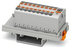
Bloc distributeur, Bloc avec orientation verticale et alimentation intégrée, tension nominale: 500 V, intensité nominale: 17,5 A, nombre de connexions: 19, type de raccordement: Raccordement Push-in, Dérivation, section : 0,14 mm<sup>2</sup> - 2,5 mm<sup>2</sup>, Raccordement collectif, Section de référence: 4 mm<sup>2</sup>, section : 0,2 mm<sup>2</sup> - 6 mm<sup>2</sup>, type de montage: NS 35/7,5, NS 35/15, coloris: gris
