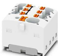
Bloc distributeur, tension nominale: 450 V, intensité nominale: 17,5 A, nombre de connexions: 7, type de raccordement: Raccordement Push-in, Dérivation, section : 0,14 mm<sup>2</sup> - 2,5 mm<sup>2</sup>, Raccordement collectif, Section de référence: 6 mm<sup>2</sup>, section : 0,2 mm<sup>2</sup> - 6 mm<sup>2</sup>, type de montage: collage, coloris: blanc
