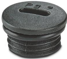
Vis de fermeture, matériau du raccordement vissé: PA, filetage de raccordement: Pg7, coloris: noir foncé RAL 9005, avec joint torique
